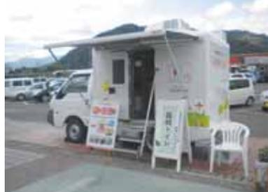
バイオトイレカーは、水を使わない、室内は無臭、汲み取り不要の移動式トイレです。自ら移動することが出来るので、自由自在に目的地へ移動し設置する事が可能です。道路の渋滞や繁忙期の臨時トイレとして、また災害発生時やイベント時の仮設トイレとして、ご利用いただけます。水が不要であるため、災害時等の断水でもトイレとして使用でき、また、汚水が出ないため、人にも環境にも優しいトイレです。糞尿に含まれる水分をオガクズに保水させ、加熱、攪拌し、蒸発させます。水分は、臭いを発生することなく蒸発し、残った固形分を微生物が分解します。特別な菌の使用は不要で、糞尿に含まれている細菌と、自然界に生息している微生物の働きで分解処理されます。
