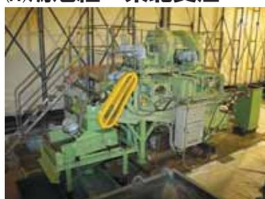
放射性セシウムに汚染された土壌を研磨洗浄により浄化し、
