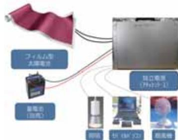
太陽電池を電源とした独立電源システムです。主に大規模震災時や停電時などの非常時に「防災拠点」で使用することを目的としています。独立電源（アタッシュケース）と専用の太陽電池シート（30W/枚）を1~6枚と12Vバッテリー（鉛蓄電池）を組み合わせ蓄電し、AC100V（コンセント）、DC12V（シガーライターソケット）、DC5V（USB）の3種の端子から出力することができます。また、フィルム型太陽電池であるため、割れることがなく安全性に優れており、軽量（1.5kg/枚）であるため、持ち運びが容易で、未使用時は丸めてケースに収納できます。
