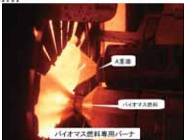
本技術は、加熱アスファルト混合物を製造する際に使用する燃料を、重油などから植物由来のバイオマス燃料（廃グリセリン）に変えることで、製造時のCO<sub>2</sub>排出量の削減を可能にするものです。従来の重油を燃料としてアスファルト混合物を製造するよりも、アスファルト混合物製造時の二酸化炭素排出量を大幅に削減することができます。
